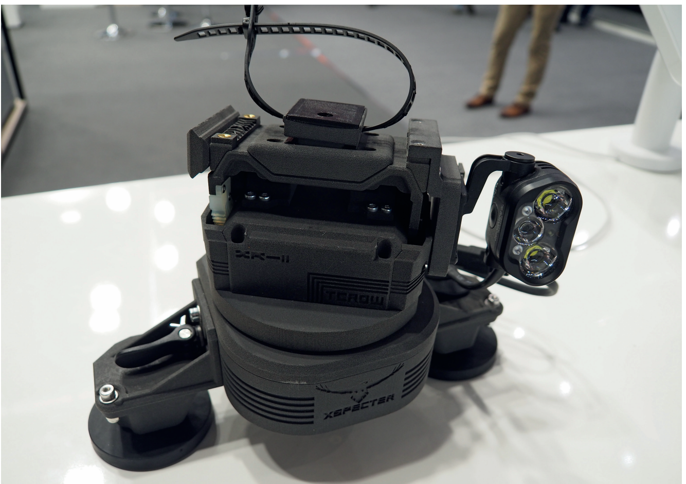
Nachtsichtkamera T-Crow: Bis auf die Komponenten der Elektronik erfolgt die Herstellung der Stative komplett additiv.
