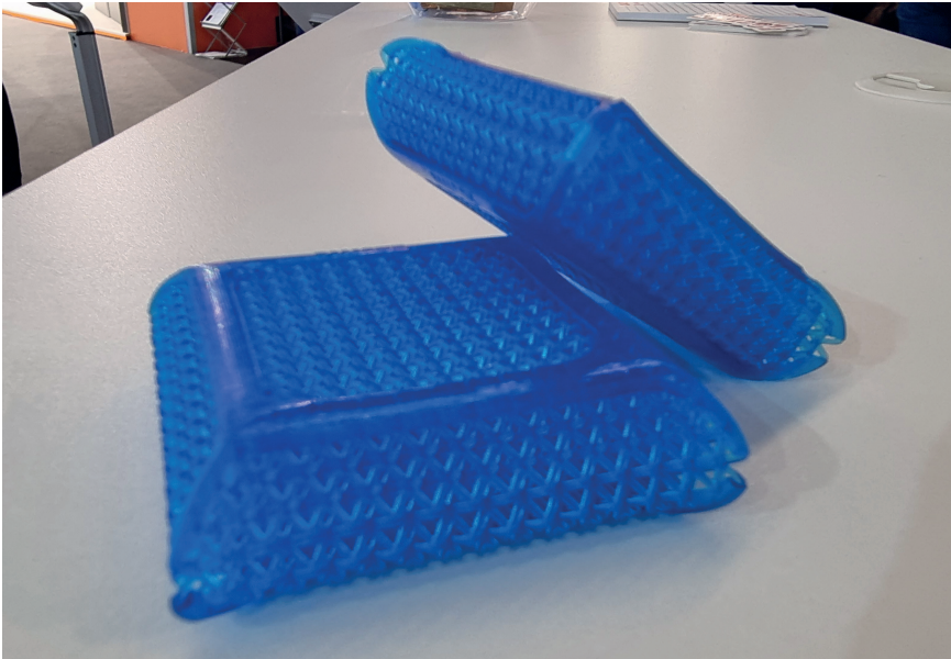
Bild 3. Für die Medizintechnik hat Henkel spezielle 3D-druckbare Acrylharze entwickelt. Sie sind zertifiziert biokompatibel. © Hanser/F. Streifinger
