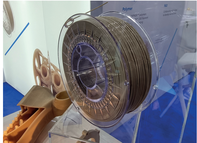
Bild 6. Das PAEK von Victrex löst ein Problem bei PEEK im 3D-Druck: die geringe Zugfestigkeit in z-Achsenrichtung. Das liegt an der geringeren Kristallisationsgeschwindigkeit des Materials. © Hanser/F. Streifinger
